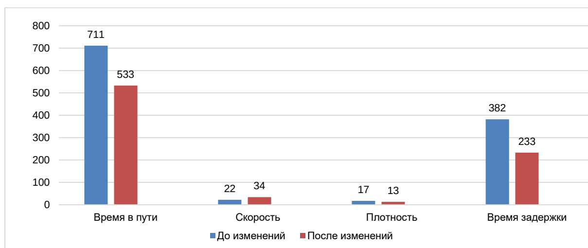
Рис. 4. Диаграмма зависимостей времени в пути, скорости транспортного потока, времени задержки и плотности до и после внесения изменений по улучшению организации дорожного движения
