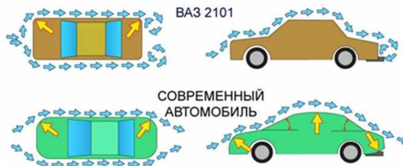
Рис. 2. Распределение потоков воздуха при движении автомобиля
