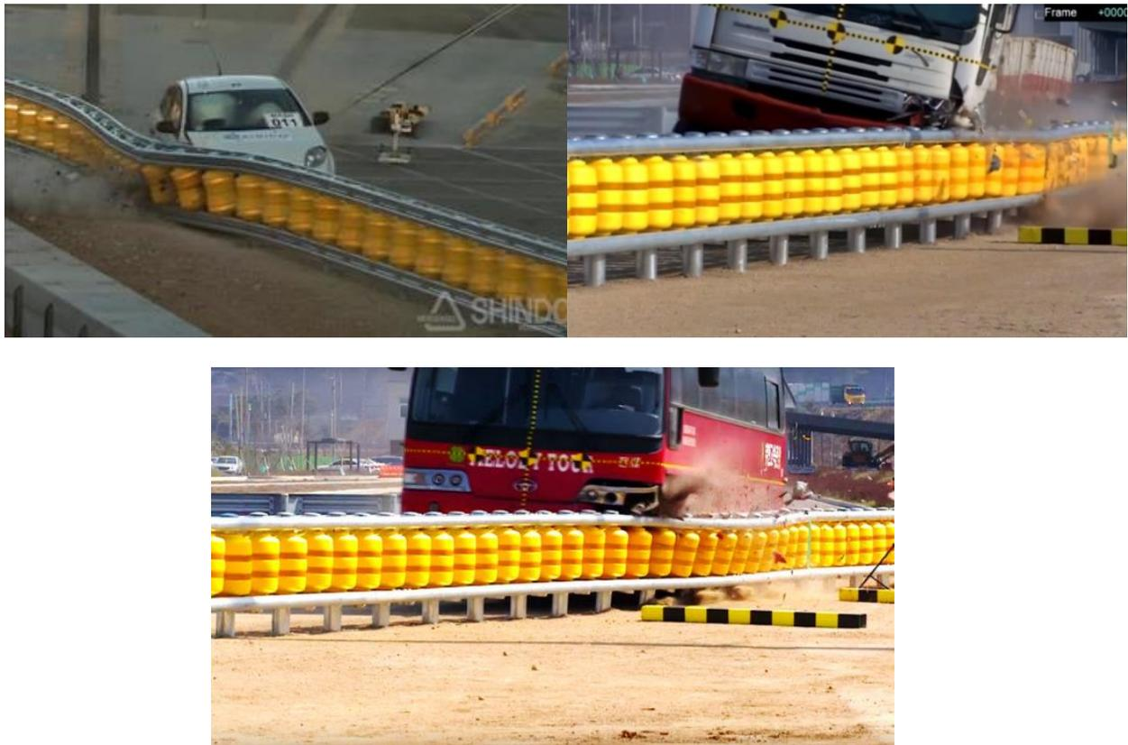
Рис. 2. Краш-тест Rolling Barrier System [4]
