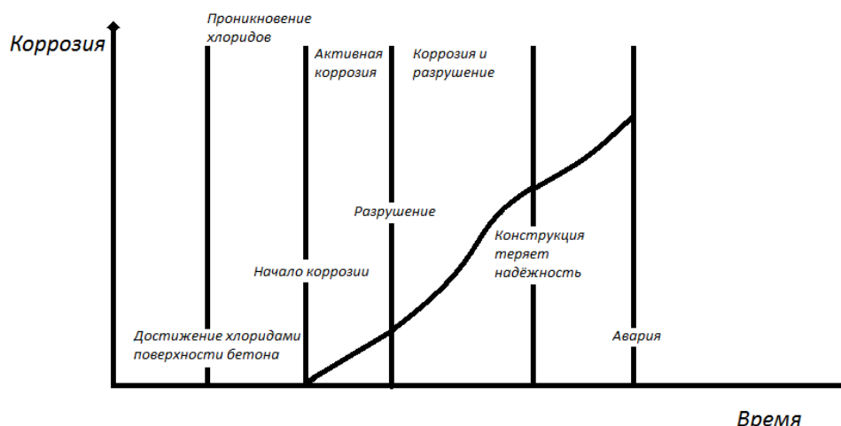
Рис. 1. Коррозионное разрушение железобетона, вызванное воздействием хлоридов
