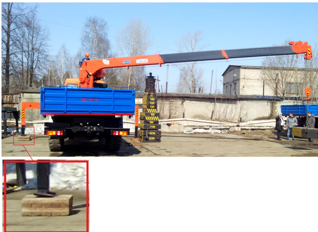
Рис.1. Крен автомобильного крана-манипулятора с отрывом передней левой выдвигающей гидравлической опоры при проведении испытаний на грузовую устойчивость
