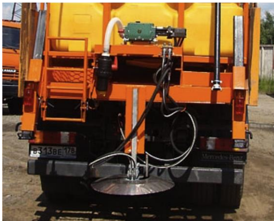
Рис. 1. Диск для распределения жидкого реагента
