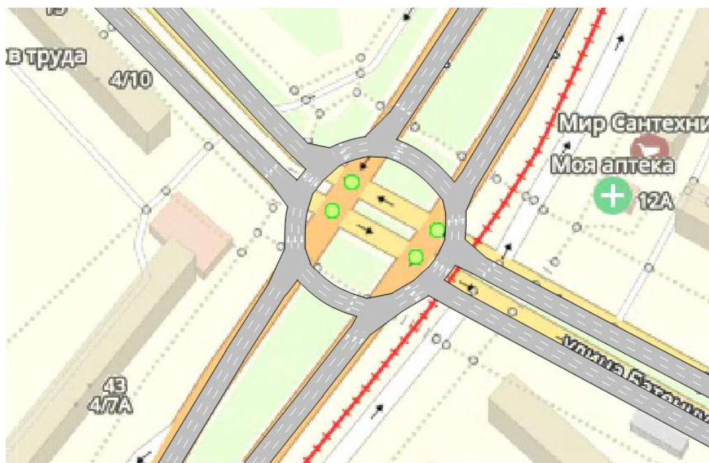
Рис. 4. Предлагаемый способ проектирования перекрестка ул. М. Джалиля – ул. Батенчука
